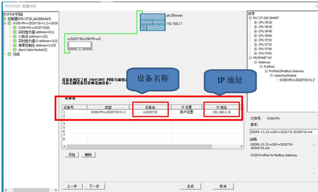
配置设备名称和 IP 地址，这里配置的设备名称必须跟控制器的设备名称完全一致（前面字母必须是小写 h，数字 0000-65535 之间），IP 地址必须跟 PLC 在同一个网段内（IP 地址需要手动分配一个，在同一网段内无重复都可以），修改完成后点击下一步。
